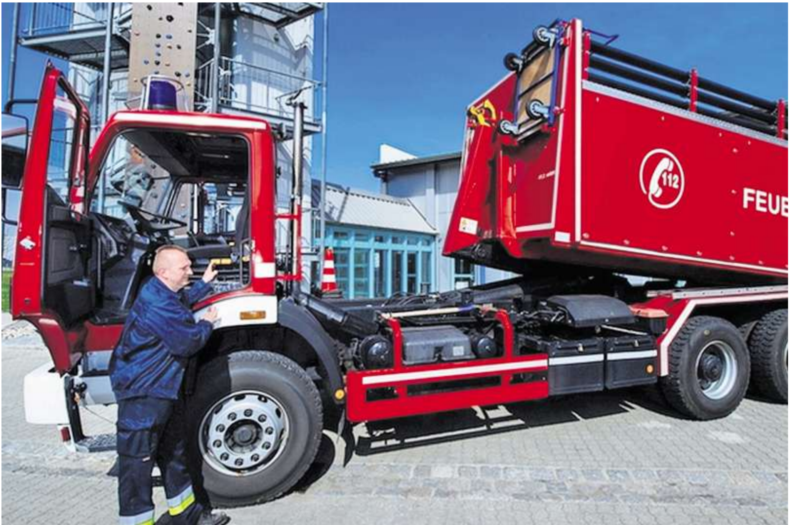
So funktioniert das Wechselladersystem: Auf einem Trägerfahrzeug können verschiedene Aufsätze angebracht werden. Das Fahrzeug der FFW Neustadt auf unserem Bild ist allerdings älteren Datums. Foto: Archiv/Dannenber
