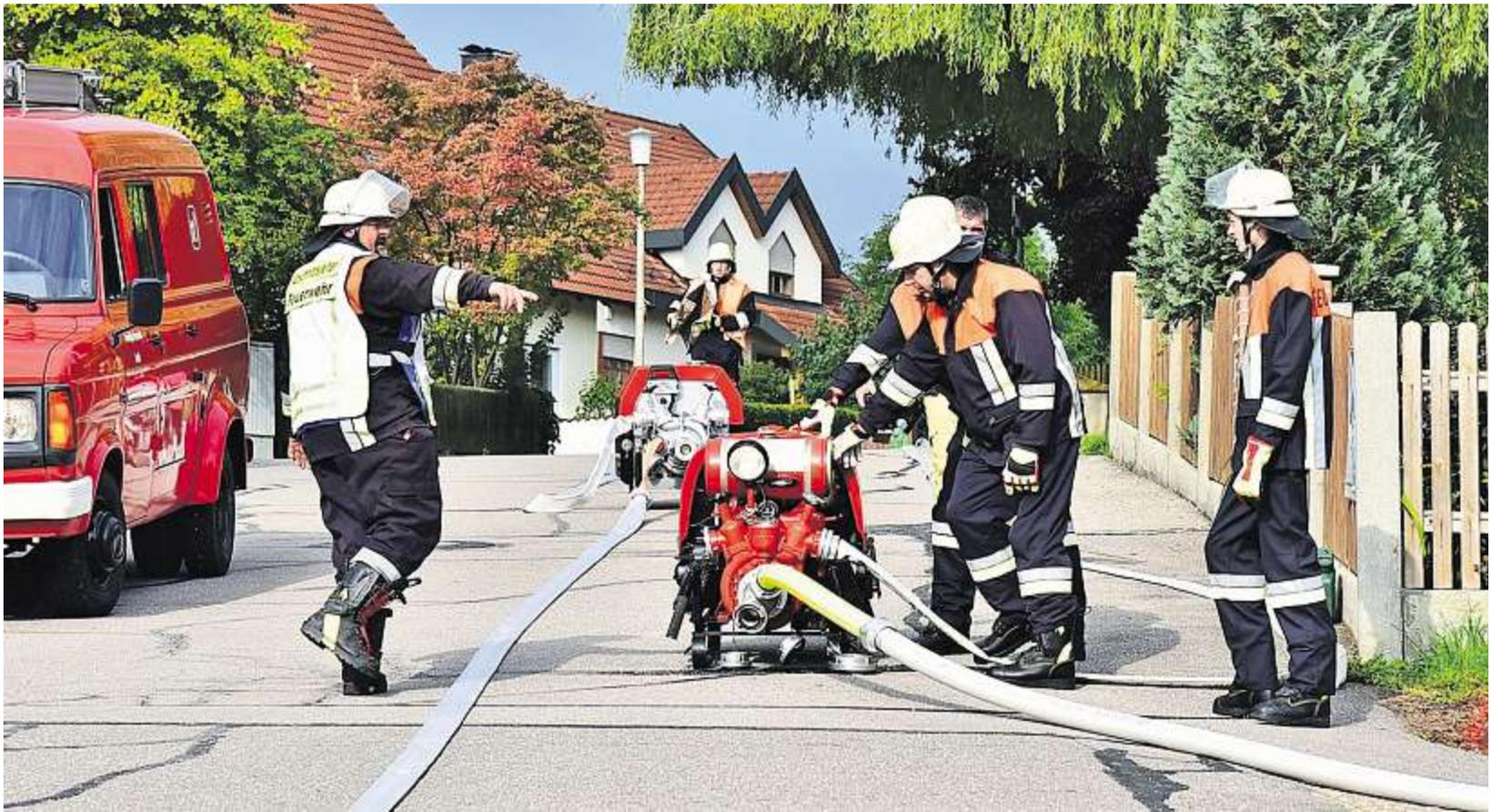
Zwei Druckerhöhungspumpen wurden auf halber Strecke installiert.
